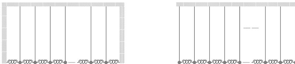
図 1: N-連成振り子．固定端（左）と自由端（右）．
